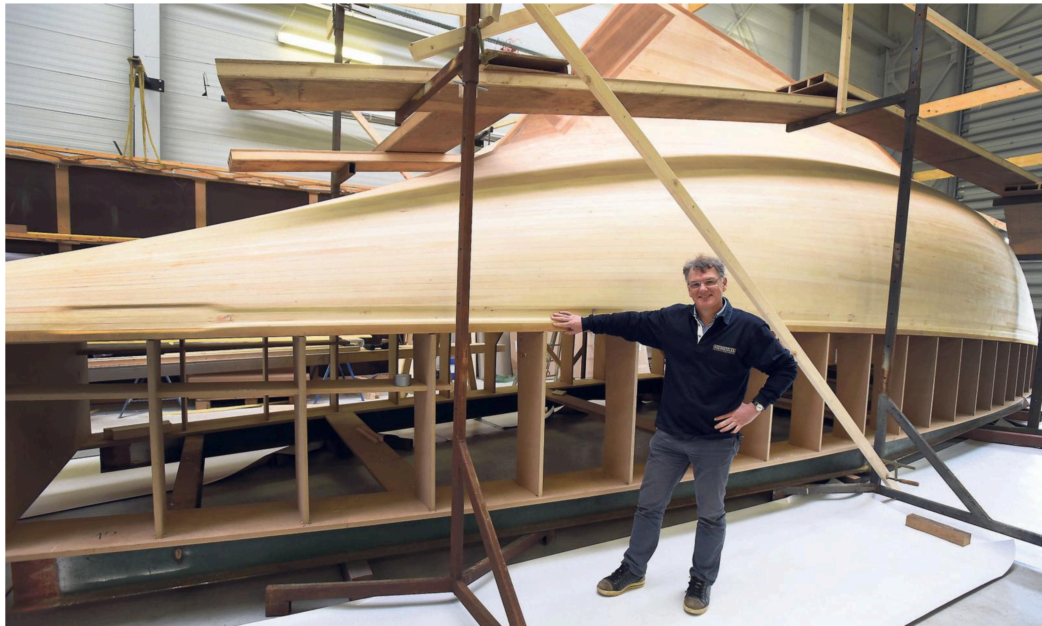
Hans Peter Baars bij de omgekeerde mal voor de romp van de Sparkman & Stephens, dat klaar is voor de eerste laag epoxy.
